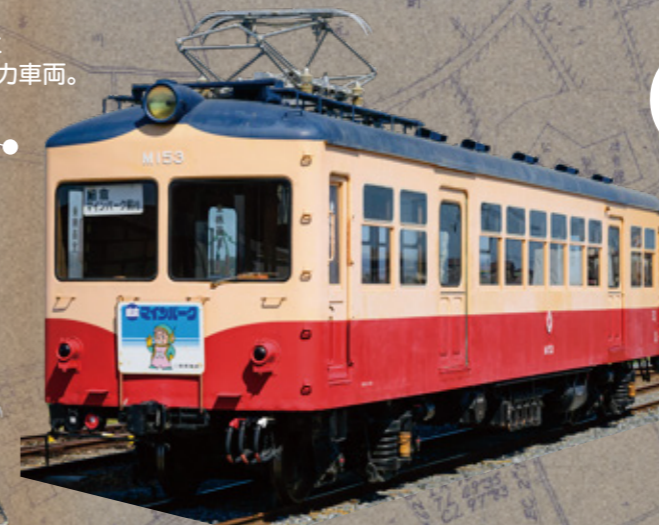
栗原電鉄時代の貨物輸送の主力。ED18からED20へ改造し活躍。
