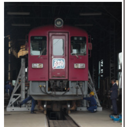
現役時代にジャッキを使って車両の検査をしている様子
